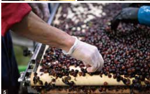
◎1/赤ワインの仕込みは醸造場内で行う。◎2/選果・選粒されたぶどうは、直接醸造タンクに向かう。◎3/選果機能付除梗機。ここでぶどうの粒と梗を分離することができる。◎4・5/さらに腐敗果などを手作業で取り除く。この作業でワインに感じる雑味を大幅に低減することができる。
